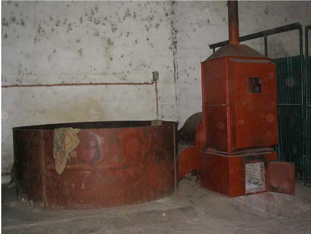
Foto # 5: Secadora de pila para café y/o cardamomo. Este tipo de secadora será utilizada para secar ramón en las comunidades del área de Chisec, Alta Verapaz
